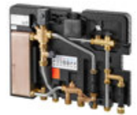
„Regudis W“ Станция для поквартирного подключения Станция с пластинчатым теплообменником для передачи тепла из центральной сети теплоснабжения в систему водоснабжения и отопления квартиры.
